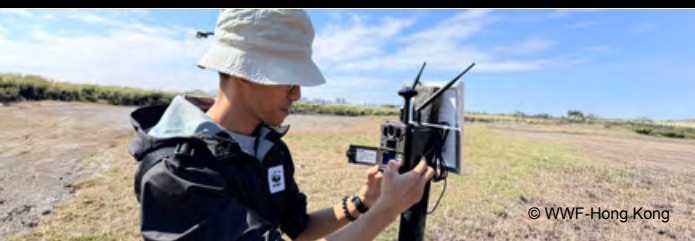
於米埔自然保護區的太陽能智能相機，專門用於監測哺乳類動物的出沒情況
